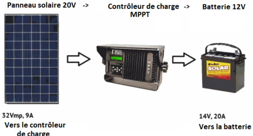
Un panneau solaire nominal de 20 V passe par un contrôleur de charge solaire MPPT afin de pouvoir charger efficacement une batterie de 12 V. Le MPPT abaisse le voltage pour ainsi maximiser l'ampérage de charge.
