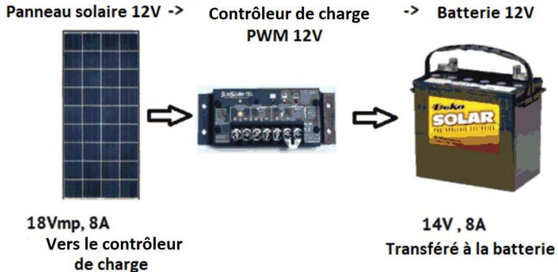
Panneaux solaires 12V chargeant une batterie 12V avec un contrôleur de charge 12V PWM traditionnel.
