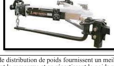
(Installation incluse avant taxes) Les attaches de distribution de poids fournissent un meilleur contrôle du véhicule et de la remorque en soulevant la remorque et en répartissant le poids plus uniformément. Center Line est recommandé avec les véhicules de type Pick-up ou VUS avec suspension rigide à l'arrière)
